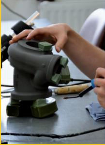
Wirst du Germany's Next Top Model (Ibauer/-in)? Ohne Modelle geht in einer Gießerei überhaupt nichts. Modelle werden für die Herstellung der Form gebraucht, in die das flüssige Metall gegossen wird. Sie bestehen meist aus Hartholz, Kunststoff
